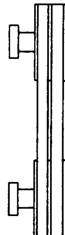
Alinhado: Eixos paralelos e polias alinhadas
